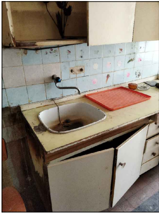
DEMONTÁŽ DŘEZU - DOD.STAVBY DEMONTÁŽ SIFONU DEMONTÁŽ VENTILU NA SV ZASLEPENÍ KANALIZACE
